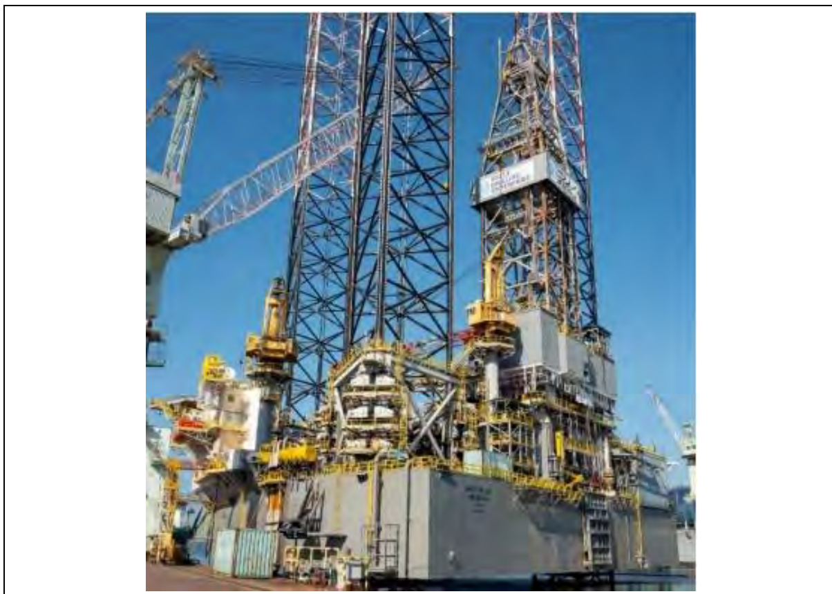
รูปที่ 2.3-1: ตัวอย่างของแท่นเจาะชนิดหยั่งติดพื้นทะเลแบบยกตัวได้ (ชื่อ Shelf Drilling Enterprise)
