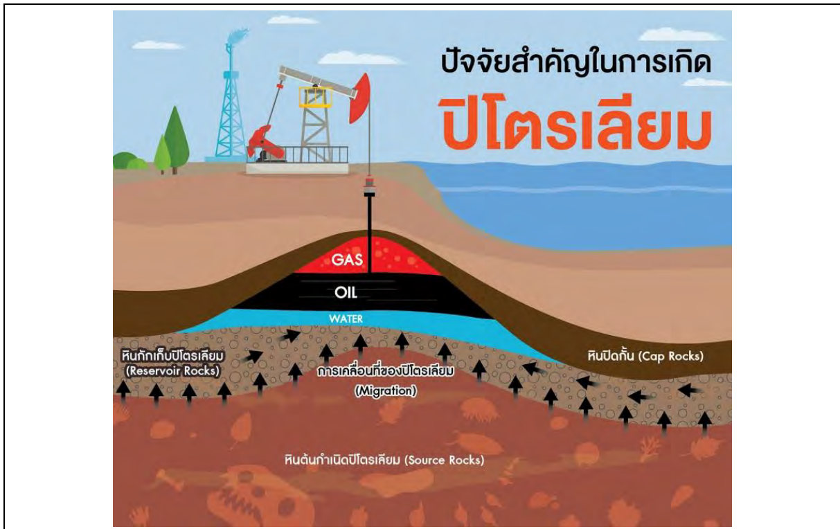
รูปที่ 2.5-3: องค์ประกอบหลักของระบบปิโตรเลียมโดยทั่วไป
