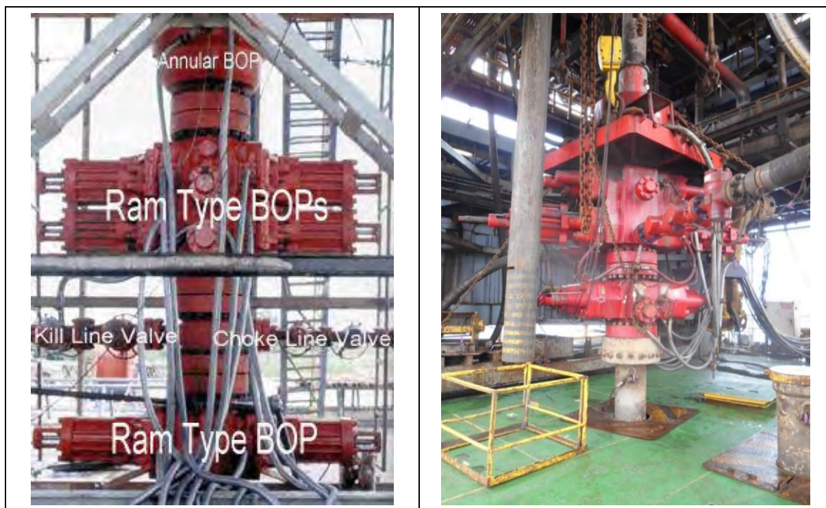
รูปที่ 2.3-2: ตัวอย่างอุปกรณ์ป้องกันการพลุ่ง (Blowout Preventer หรือ BOP) ที่ติดตั้งที่ปากหลุม
